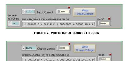
FIGURE 8. WRITE CHARGE VOLTAGE BLOCK
