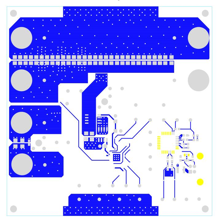
FIGURE 19. BOTTOM COPPER (BOTTOM VIEW)
